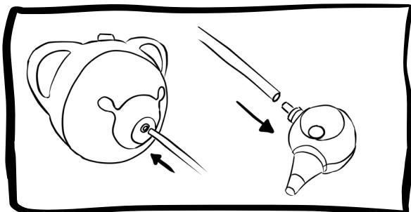
a) 吸引チューブを鼻水カップと本体の吸引チューブ差込口に装着してください。
