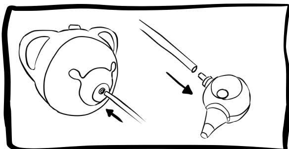
a) Connectez le tube d'aspiration au dispositif et à la tête Colibri.
